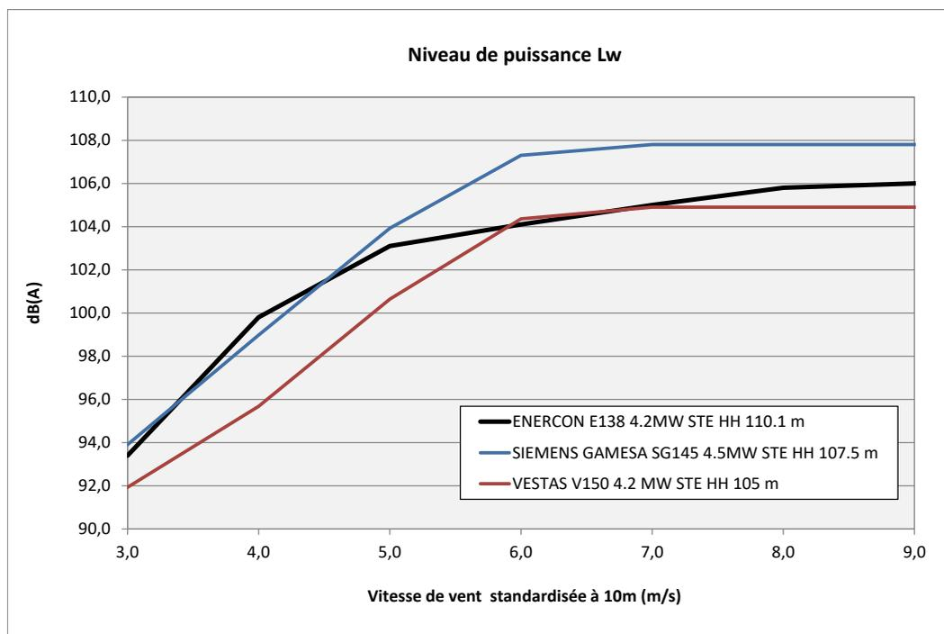
Figure 15 : Niveaux de puissance acoustique  $L_w$  des éoliennes
