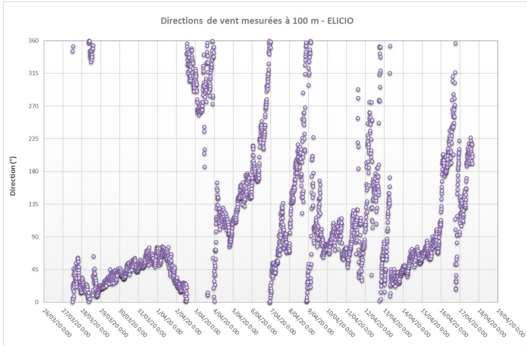
Figure 26 : Directions de vent à 100 m de hauteur observées
