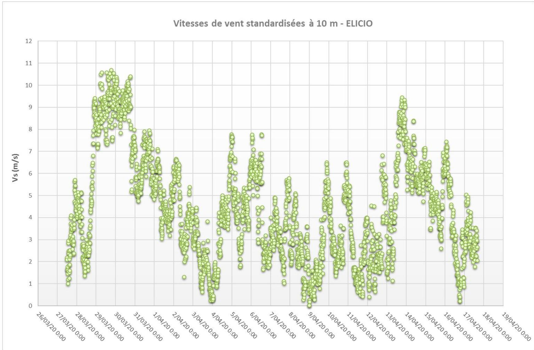
Figure 25 : Vitesse de vent standardisée à partir des vitesses mesurées à 100 m
