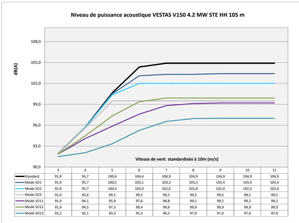
Figure 20 : Modes de fonctionnement réduit VESTAS V150 4.2 à 6 MW STE HH = 105 m
