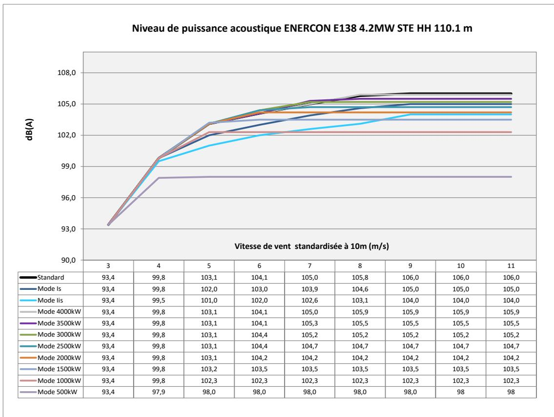
Figure 18 : Modes de fonctionnement réduit ENERCON E138 4.2MW STE HH = 110,1 m
